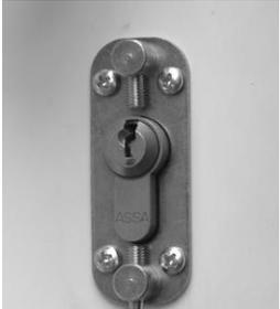
Setzen Sie jetzt die Unterplatte über den Profilzylinder. Zeichnen Sie die 4 Bohrungen entsprechend an. Bohren Sie mit einem 3mm Metallbohrer die entsprechenden Schraublöcher vor. Befestigen Sie dann die Unterplatte mit den beiliegenden Schrauben.
