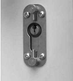
Lösen Sie jetzt den Profilzylinder und ziehen Sie ihn bis hinter die Unterplatte zurück. Schrauben Sie die Einstellschrauben nach innen, sodass diese nach oben und unten nicht vorstehen.
